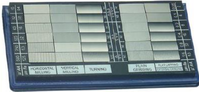
Taktilne normale za primerjanje hrapavosti
